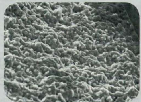
Abb. 2: Im Vergleich dazu eine mit bis zu 25 Prozent Aluminiumoxidanteil angereicherte ATZ-Keramik
